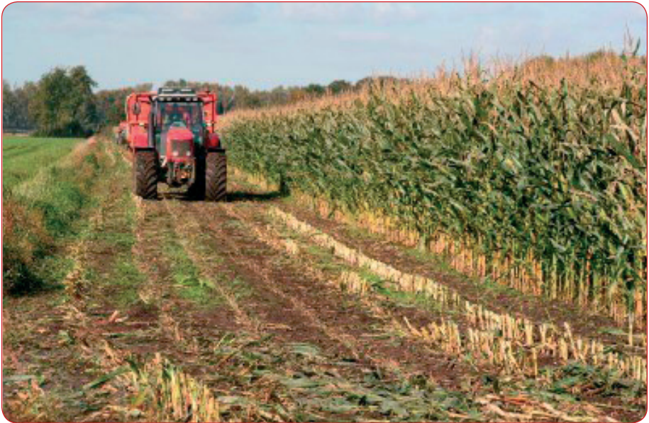
Լավ հարմարեցված հավաքման մեքենան պարտադիր է ճիշտ չափի մասնատված եգիպտացորենի սիլոս ստանալու համար
